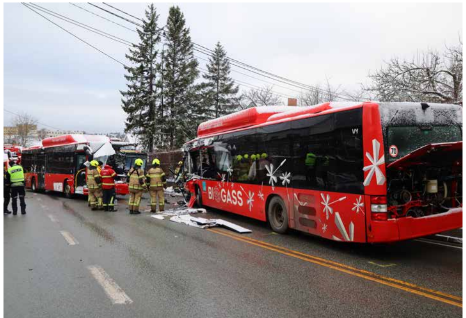
Bussene fotografert på ulykkesstedet. Til tross for lav hastighet var begge førerplassene smadret.
