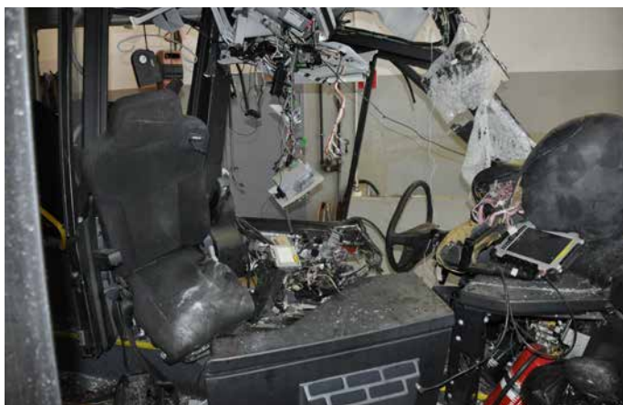
Førerplassen på buss A, der føreren hadde «overlevelsesrom» på øvre del, mens området nedenfor setehøyde ble sammenklemt.
